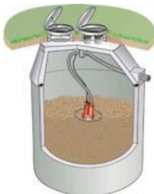
Abb. 9: Erdlager aus Beton mit Saugentnahme von oben
